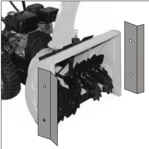
Некоторые модификации снегоуборщика укомплектованы стальными пластинами, которые устанавливаются на боковые стороны снегоуборщика. Они предназначены для увеличения ширины захвата и используются для свежевыпавшего снега не более 30см.
