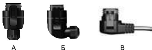
Рис. 15. А – ALPHA штекер с кабельным вводом (поставляется в комплекте), Б – разъем ALPHA – изгиб 90°, стандартное кабельное соединение и В – угловой ALPHA штекер с монтированным кабелем 4 метра
