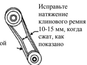
Рисунок 2. Натяжение клинового ремня
