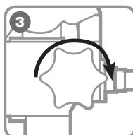
**Поверните винт сброса давления в положение «Закрыть»**
