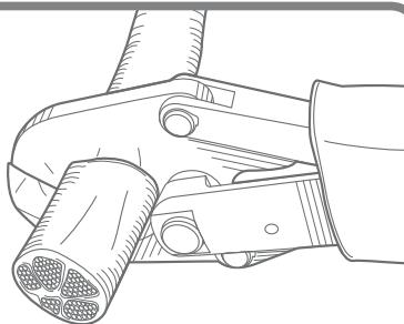
**Нажмите на кнопку «ПУСК» и держите нажатой ее до срабатывания механизма автоматического сброса давления. При этом раздается характерный щелчок.**
